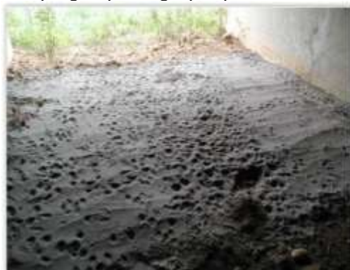
Piège à traces avec du Limon en passage inférieur. Source Vanpeene-Bruhier, 2005.
