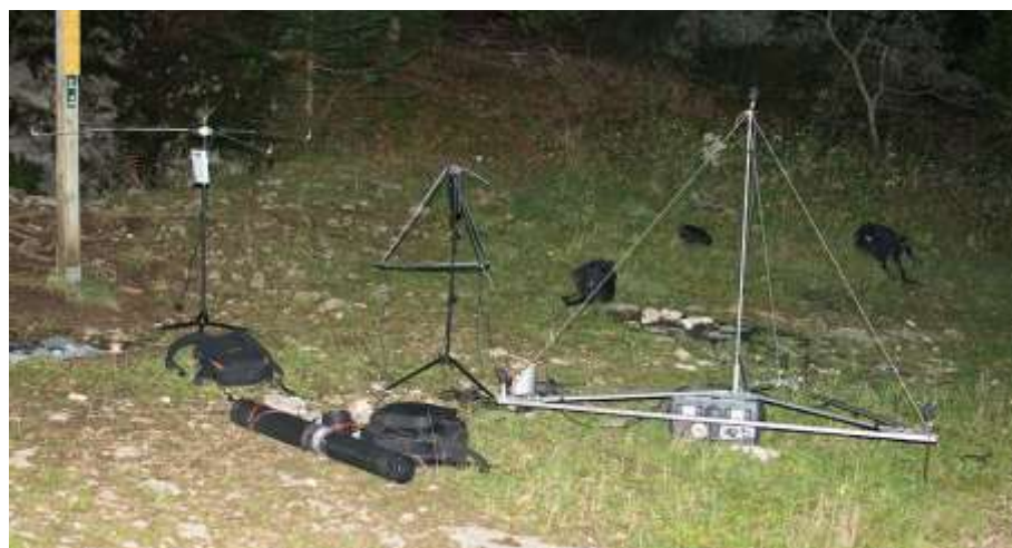
Trois équipements différents pour la triangulation. Les récepteurs sont tous conçus sur le principe d'un microphone fixé à chacune des 4 extrémités d'un tétraèdre. Les microphones sont reliés à un équipement informatique qui permet de déterminer les différences de temps d'un même signal arrivant sur chacun des 4 micros. A gauche, un équipement utilisé par le MNHN (Y. Bas), au milieu par l'université des sciences de Toulon (H. Glotin) et à droite par la société Cyberio (M. Charbonnier et D. Mauuary). Photo : CC BY SA O. Pichard.
