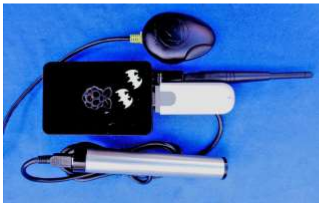
Raspberry pi connecté à un micro ultramic. source : http://www.fledermausschutz.de/
