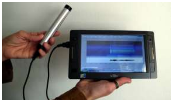
L'ultramic connecté à une tablette windows. Source : http://www.dodotronic.com/
