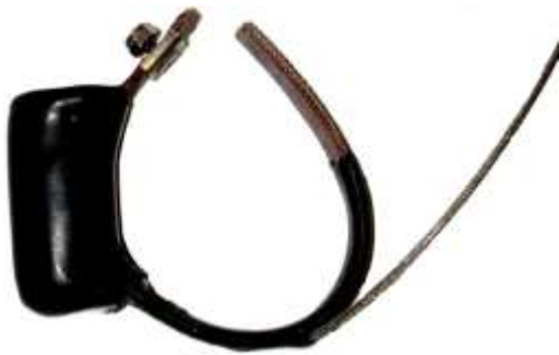
Figure 8 : Collier émetteur - Modèle MI-2 (Source : Holohil.com)
